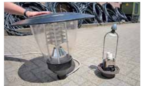
Straßenbeleuchtung im Wandel der Zeit: eine moderne Pilzleuchte mit Kompaktleuchtstofflampe (links) neben dem Innenleben einer Opalglaspilzleuchte mit Quecksilberdampfleuchtmitte aus den 50er Jahren
